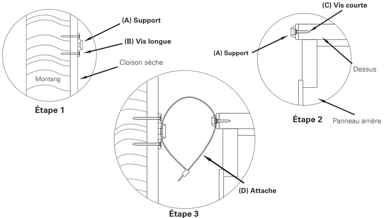
**A.** Repérez un montant de mur derrière la commode-coiffeuse. (Le montant est la pièce de bois solide qui immobilisera le meuble. Vous devez utiliser cette pièce solide, et non uniquement la cloison sèche, pour y insérer les vis). Positionnez le support mural (A) sur le montant et légèrement en dessous du dessus du meuble. Marquez l'emplacement et percez un trou au centre du montant avec un foret de 2,4 mm (3/32 po). Fixez le support mural au montant avec les vis longues (B).
