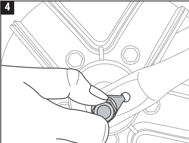
**ÉTAPE 4** - Assurez-vous que la languette de la rondelle en forme de larme est alignée au-dessus du trou sur la fourche avant, comme illustré. Répéter pour l'autre côté.
