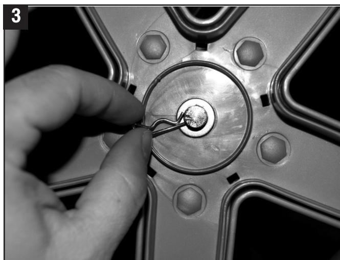
**ÉTAPE 3** - Retirez la goupille du trou situé sur l'essieu. Retirez la rondelle de l'essieu. Retirez la roue arrière de l'essieu. Remarque : Conservez les goupilles et les rondelles pour les installer sur les roues de rechange.
