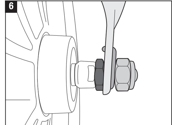
**ÉTAPE 6** - Serrez jusqu'à ce que la fourche de la roue avant touche l'intérieur du boulon noir et la rondelle en forme de A. Répéter pour l'autre côté.
