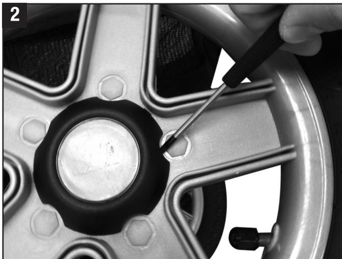
**ÉTAPE 2** - Retirez le cache-moyeu de la roue arrière en utilisant le tournevis à tête plate. Soulevez fermement le cache-moyeu pour le déloger de la roue.
