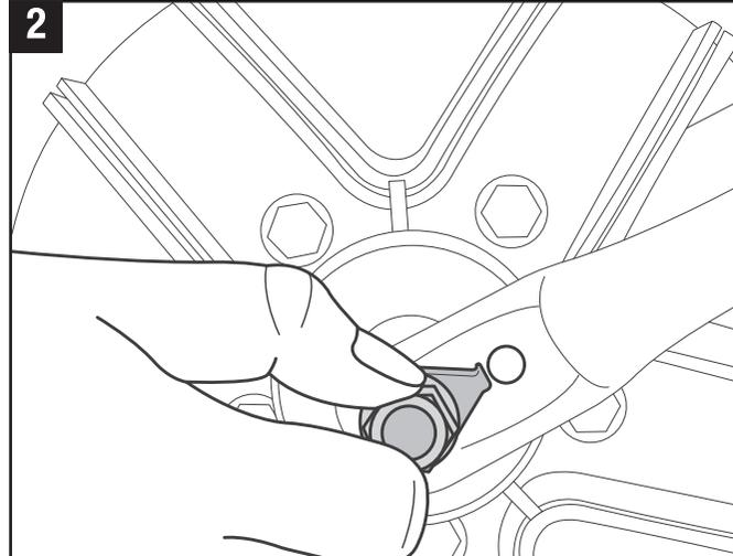
**ÉTAPE 2** - Retirez la languette de la rondelle en forme de larme du trou situé sur la fourche avant. Répéter pour l'autre côté. Retirez la roue de la fourche avant..
