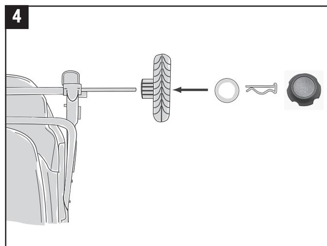
**ÉTAPE 4** - **INSTALLATION DE LA ROUE ARRIÈRE DE RECHANGE** Installez la nouvelle roue arrière sur l'essieu. Faites glisser la rondelle sur l'essieu. Glissez la partie plate de la goupille dans le trou d'essieu. Insérez le cache-moyeu sur la roue. Répétez les étapes 2 à 4 pour l'autre roue arrière.
