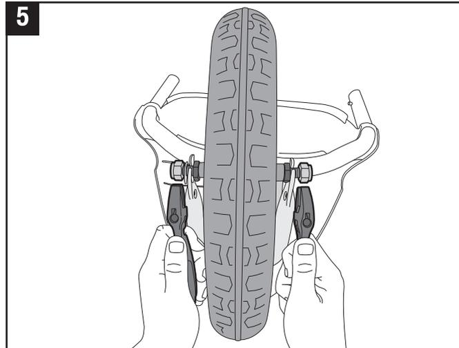
**ÉTAPE 5** - Tout en immobilisant un écrou extérieur avec la première clé, utilisez l'autre clé pour visser l'écrou extérieur sur le côté opposé.
