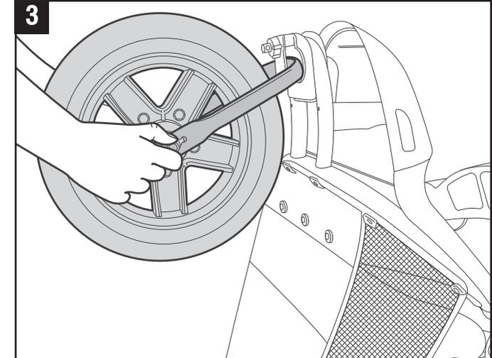
**ÉTAPE 3** - **INSTALLATION DE LA ROUE AVANT DE RECHANGE** Vous devrez sans doute desserrer les écrous aux deux extrémités de l'essieu pour laisser de la place pour la fourche de la roue avant.
