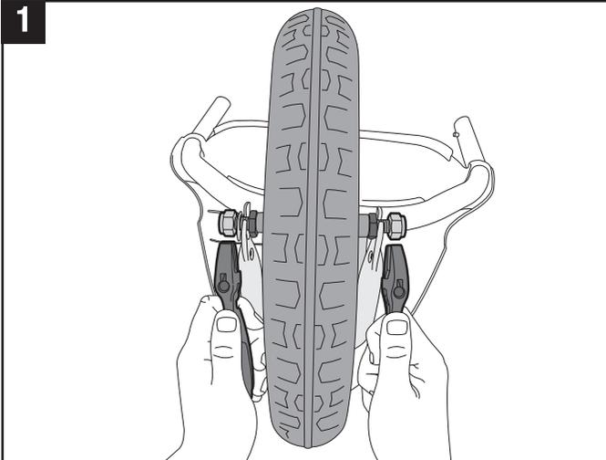
**ÉTAPE 1** - Positionnez la poussette de manière à ce que la poignée et les roues arrière reposent complètement sur le sol. Tout en immobilisant un écrou extérieur avec la première clé, utilisez l'autre clé pour visser l'écrou sur le côté opposé. Répéter pour l'autre côté.
