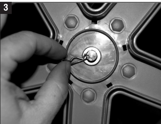
**PASO 3** - quite la chaveta del orificio del eje. Quite la arandela del eje. Quite la rueda trasera del eje. Nota: guarde las chavetas y las arandelas para instalar las ruedas nuevas.
